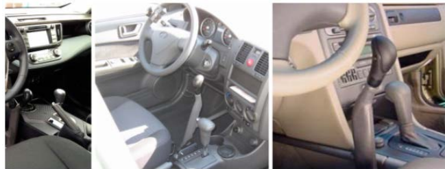
Рис. 2. Приклади встановлення механізмів ручного керування на транспортний засіб: а — не забезпечується керування; б — забезпечується керування
