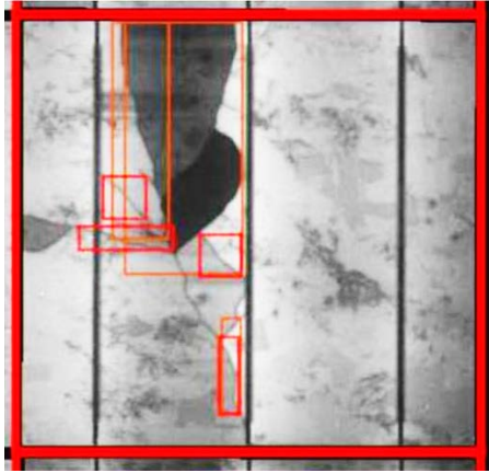
Рис. 1. Мікротріщини в сонячному елементі
