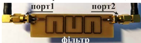
Рис. 3. Експериментальна модель досліджуваного смугового фільтра на основі трьох кільцевих резонаторів, з'єднаних каскадно
