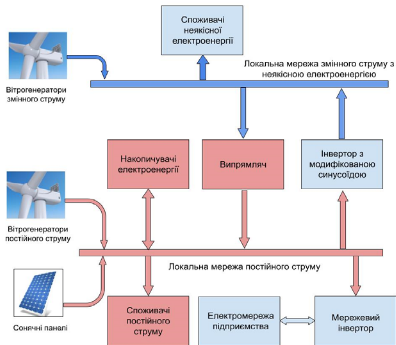
Рис. 1. Структурна схема підключення відновлюваних джерел енергії до електромережі промислового підприємства
