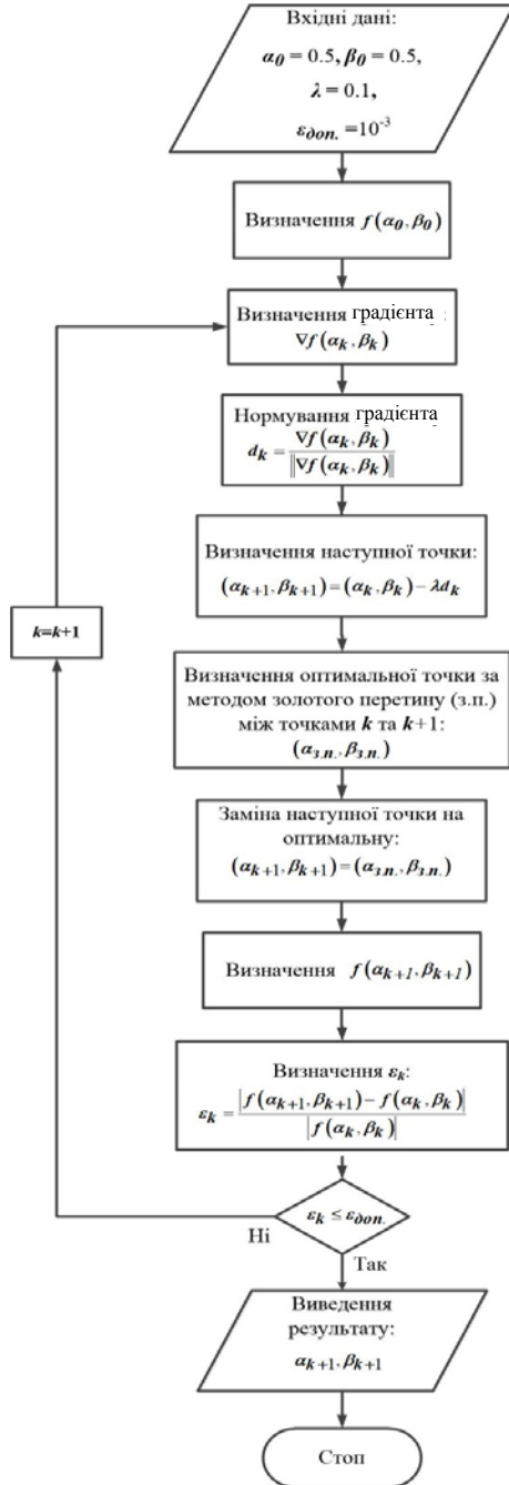
Рис. 2. Блок-схема алгоритму градієнтного спуску: f(\alpha, \beta) — цільова функція; \alpha_k, \beta_k — параметри, за якими відбувається оптимізація; \lambda — кроковий множник; \epsilon_{\text{доп}} — критерій зупинки градієнтного спуску
