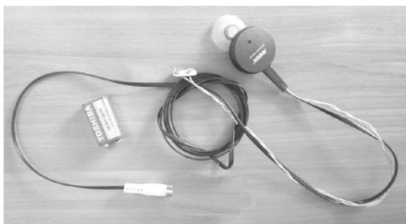
Рис. 4. Антена з підсилювачем для знімання інформації з екрана монітора
