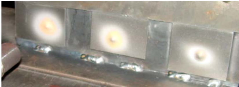
Рис. 9. Результати напилення для дистанцій справа наліво 10 мм, 30 мм, 50 мм
